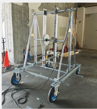
モーター：750W フレーム：L字アングル タイム：33秒 ※ノーパンクタイヤ 総重量：100kg コスト：14万円
