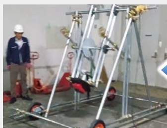
モーター：1400W フレーム：単管パイプのみ タイム：39秒 総重量：161kg
