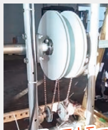
幻のデュアルモーター版 モーター：750W×2 走行中に破損
