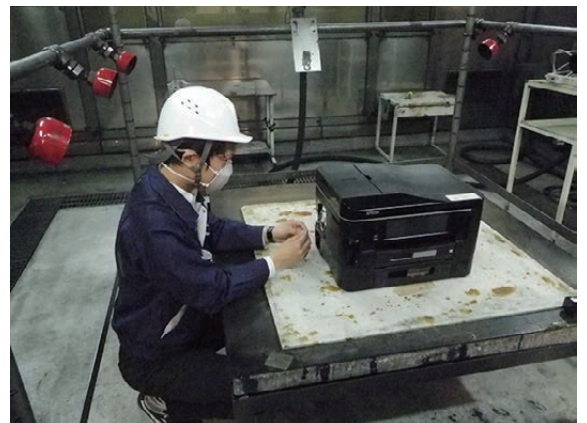
燃焼実験室における燃焼性試験
