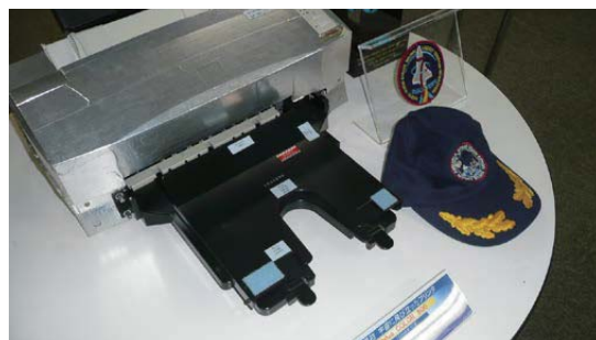
宇宙船搭載用として認定されたカラーインクジェットプリンター
