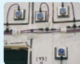
試験体に取り付けられたエプソンのセンシングシステム
