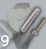
世界初のクォーツウオッチを実現した音叉型水晶振動子
