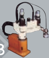
ウオッチ組み立ての自動化から始まった精密組立ロボット
