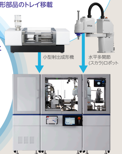
射出成形～検査～トレイ詰めまでを柔軟に対応できる、汎用性と拡張性を備えたコンパクトな生産システム
