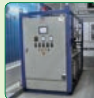
廃棄インク液を電気と薬品で分離させる装置
