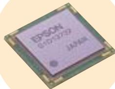
低消費電力で動画の録画・再生可能なカメラ付き携帯電話向け動画対応表示コントロールLSI "Mobile Graphics Engine" [S1D13732]
