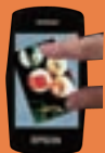
カバーとタッチパネルを 一体化した液晶ディスプレイ
