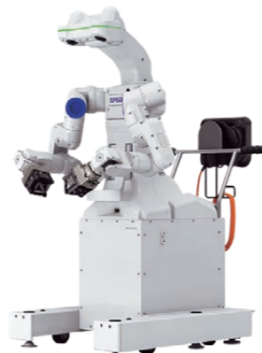
2本のアームを自在に動かして作業する自律型双腕ロボット
