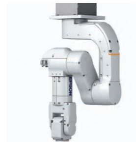
世界初 2) の折りたたみ式 新小型6軸ロボットN2シリーズ
